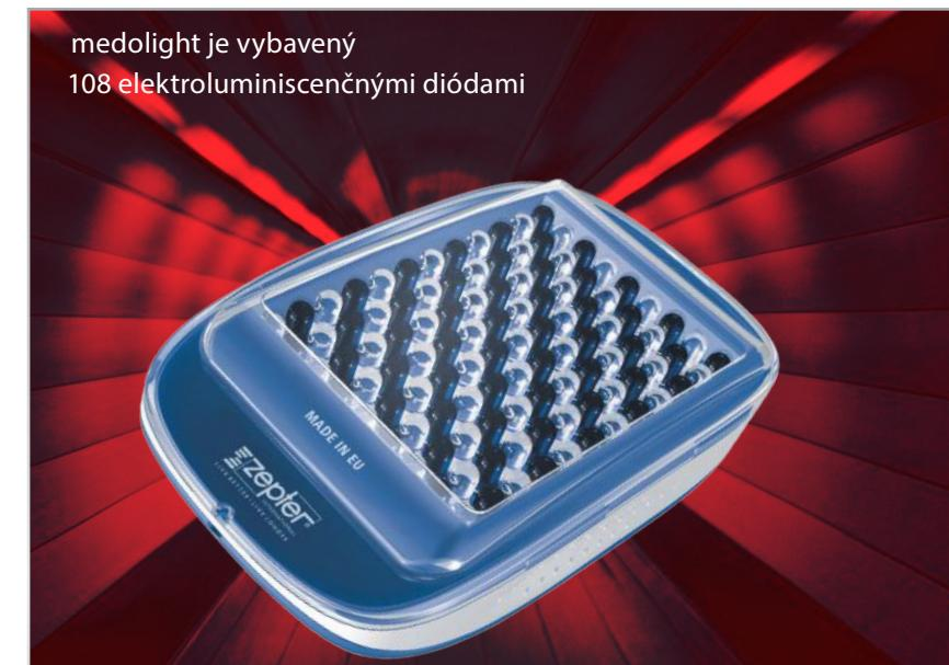
Prístroj medolight je vybavený 108 elektroluminiscenčnými diódami, v ktorých sú ako polovodiče použité gálium, hliník a arzén. Diódy vytvárajú elektromagnetické vlny v rámci červeného a časti infračerveného svetelného spektra.
